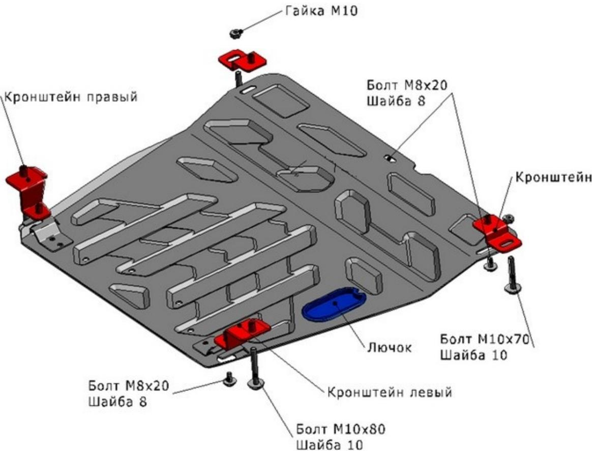
3.Заднюю часть защиты двигателя надеть на установленные болты. На автомобиле с МКП: переднюю часть защиты крепить штатными болтами в места крепления пыльника автомобиля. На автомобиле с АКП: переднюю часть защиты крепить к установленным кронштейнам и подрамнику болтами M8x20.
