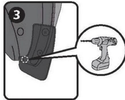
Разметить отверстие и выполнить сверление согласно рисунку. Диаметр сверла: 8мм.
