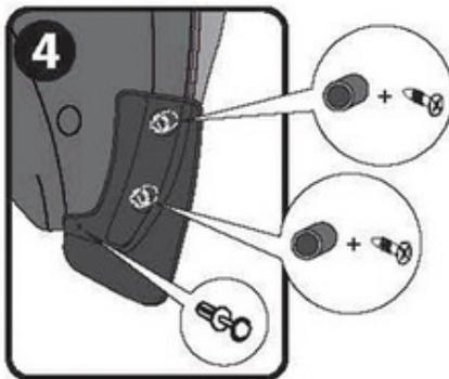
**ВАЖНО! Установку брызговика начать со средней точки.** Установите крепежные элементы согласно рисунку и надежно зафиксируйте их.
