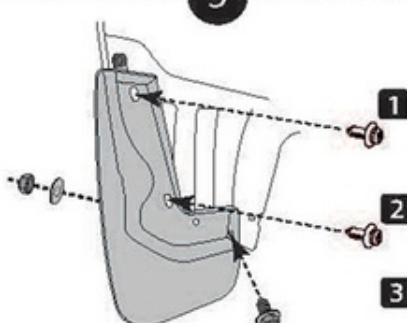
Установить брызговик. В точках 1 и 2 зафиксировать клипсами с резьбой из комплекта поставки. В точку 3 установить винт, гайку и шайбу из комплекта поставки.
