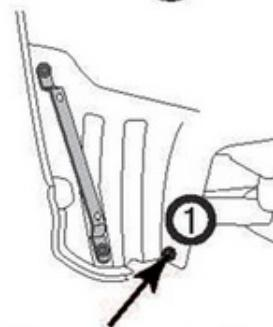
Снять брызговик, в отмеченной точке 1 используя сверло Ø 8 мм просверлите отверстие в подкрыльке.
