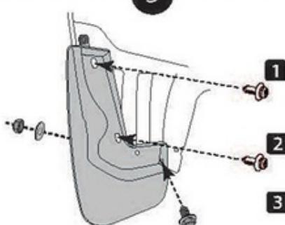
Установить брызговик. В точках 1 и 2 зафиксировать клипсами с резьбой из комплекта поставки. В точке 3 установить винт, гайку и шайбу из комплекта поставки.
