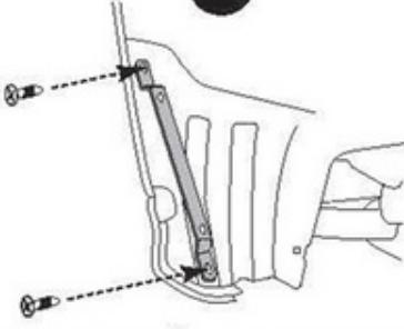
Установить кронштейн из комплекта поставки, зафиксировать штатными саморезами.
