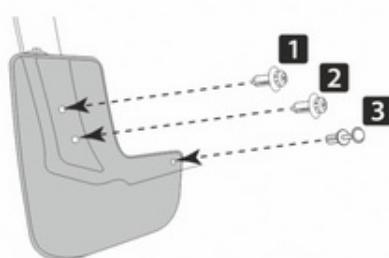
Установить брызговик. В точках 1 и 2 зафиксировать клипсами с резьбой из комплекта поставки. В точку 3 установить пластиковый фиксатор из комплекта поставки.
