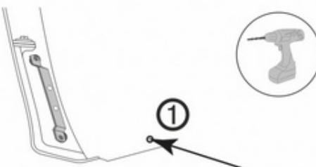
Снять брызговик, в отмеченной точке 1 используя сверло Ø 8 мм просверлить отверстие в подкрыльке.
