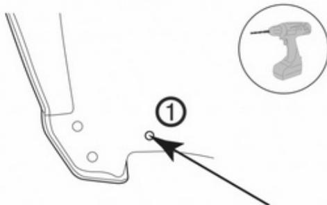
Используя сверло Ø 8 мм, просверлить
