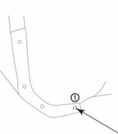
Используя сверло Ø 7 мм, просверлите отверстие в подкрыльке в отмеченной точке.
