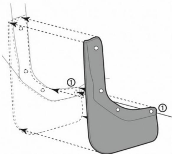
Произведите визуальную примерку, приложив изделие к месту планируемой установки. Согласно отверстию 1 на брызговике, отметьте точку для сверления в подкрыльке.
