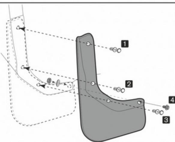
Установите на штатные пластиковые фиксаторы в точках 1, 2 и 3. В точке 4 установите винт M6x20 DIN 6921, шайбу и гайку из комплекта поставки.
