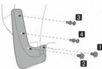
В точках 1 и 2 установите ранее демонтированные штатные винты. В точках 3 и 4 установите пластиковый фиксатор 8x25x13 из комплекта поставки.
