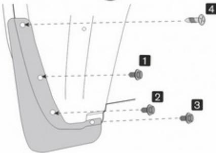
В точках 1,2 и 3 установите ранее демонтированные штатные винты. В точке 4 установите саморез 4,2x16 из комплекта поставки.
