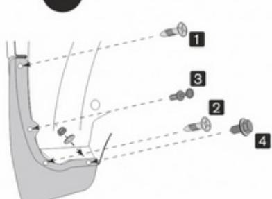
В точке 3 установите новый пластиковый фиксатор из комплекта поставки. В точках 1 и 2 установите саморезы 4,2x16 из комплекта поставки. В точке 4 установите винт M6x20 DIN 6921, гайку и шайбу из комплекта поставки.
