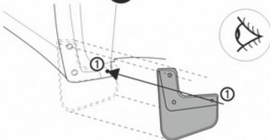
Произведите визуальную примерку, приложив изделие к месту планируемой установки. Согласно отверстию 1 на брызговике, отметьте точку для сверления в колесной арке.
