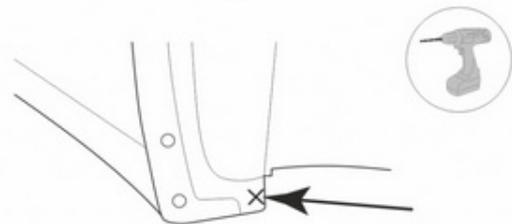
Используя сверло Ø 8 мм, просверлите отверстие в отмеченном месте.
