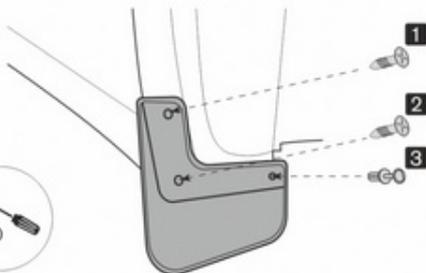
В точках 1 и 2 установите ранее демонтированные штатные саморезы. В точку 3 установите пластиковый фиксатор из комплекта поставки.
