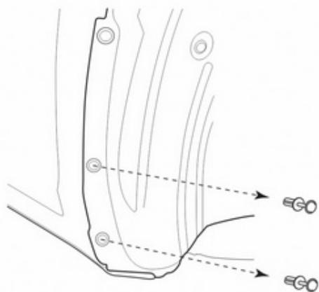
Произведите демонтаж 2-х штатных пластиковых фиксаторов.
