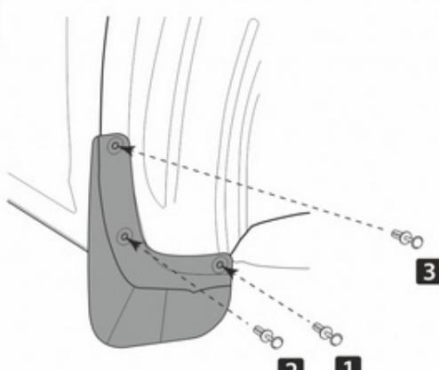
В точке 1, используя шуруповерт со сверлом Ø 8 мм, просверлите отверстие в подкрылье. В точках 1, 2 и 3 установите пластиковые фиксаторы из комплекта поставки.
