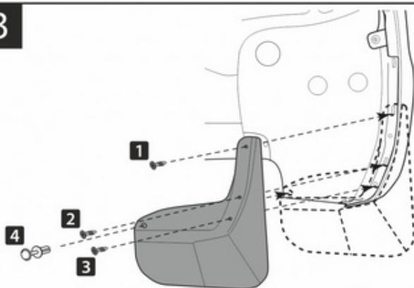
Установить брызговик: на саморезы в точках крепления скоб 1, 2 и 3. В точке 4, используя шуруповерт со сверлом Ø 8 мм, просверлите отверстие в подкрылке и установите клипсу из комплекта поставки.
