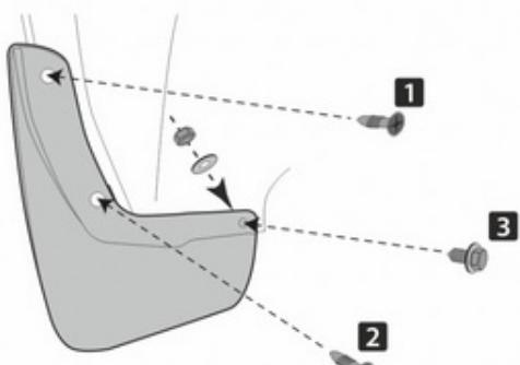
Установить брызговик: на саморезы в точках крепления скоб 1 и 2. В точке 3, используя шуруповерт со сверлом Ø6 мм, просверлите отверстие в подкрыльке и установите винт, гайку и шайбу из комплекта поставки.
