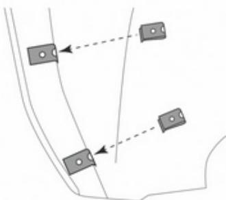
Произведите демонтаж заднего штатного подкрылька. Установите скобы из комплекта поставки.
