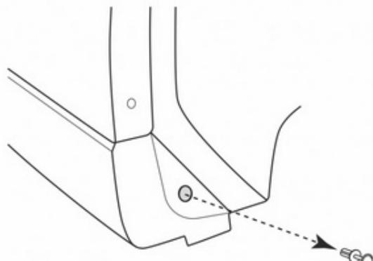
Произведите демонтаж штатного пластикового фиксатора.
