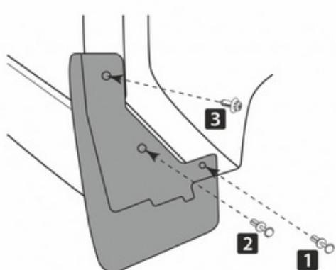
В точке 1, используя шуруповерт со сверлом Ø 8 мм, просверлите отверстие в колесной арке автомобиля. В точках 1 и 2 установите пластиковые фиксаторы из комплекта поставки. В точку 3 установите пластиковый фиксатор с резьбой.
