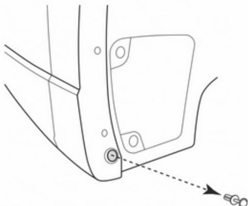
Произведите демонтаж штатного пластикового фиксатора.
