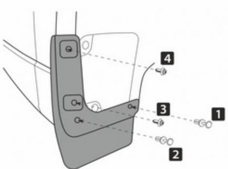
В точке 1, используя шуруповерт со сверлом Ø 8 мм, просверлите отверстие в колесной арке автомобиля. В точках 1 и 2 установите пластиковые фиксаторы из комплекта поставки. В точках 3 и 4 установите пластиковые фиксаторы с резьбой.
