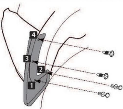
В точках 1 и 2 просверлите отверстия сверлом Ø 8 мм. и установите пластиковые фиксаторы из комплекта поставки. В точках 3 и 4 установите в скобы саморезы из комплекта поставки.
