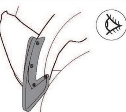
Проверьте надежность монтажа изделия и убедитесь, что оно плотно примыкает к месту установки. Затяните ранее ослабленное крепление подкрылка.
