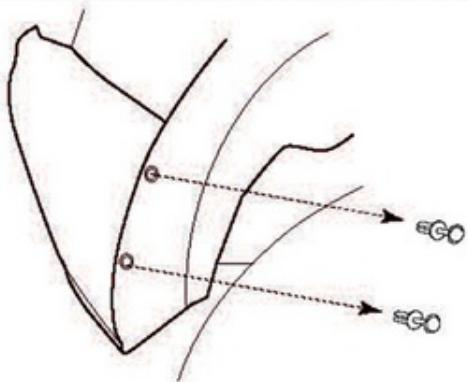
Ослабьте крепление подкрылка таким образом, чтобы его можно было отогнуть в зоне крепления брызговика.
