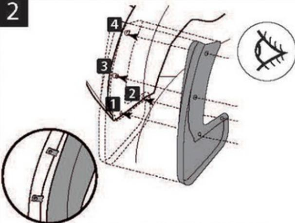
Проведите визуальную примерку изделия, приложив к планируемому месту монтажа. В точках 1 и 2 отметьте места под сверление. В точках 3 и 4 установите гайки-скобы из комплекта поставки, предварительно отогнув пластиковый подкрылок.
