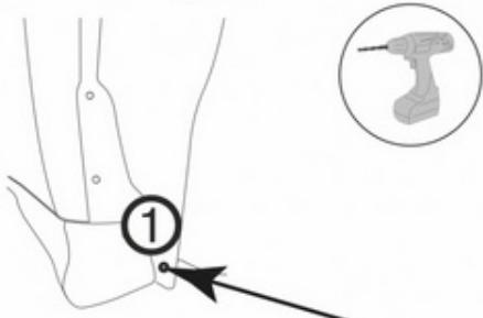
Используя сверло Ø 8 мм, просверлить
