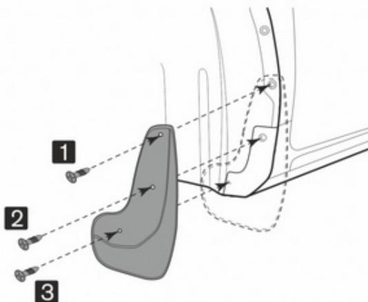
Установите саморез из комплекта (с фланцем) в точку 1 и саморез из комплекта (4,2x16) в точку 3. В точке 2 используйте штатный саморез, демонтированный в шаге 1.
