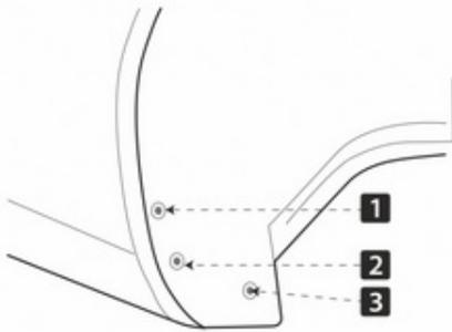
Используя шуруповерт, произведите демонтаж трех штатных саморезов.
