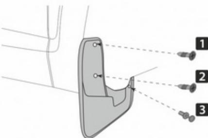
Установите штатные саморезы в точках 1 и 2. В точке 3 установите штатный пластиковый фиксатор.
