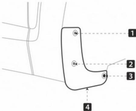
Используя шуруповерт, открутите два штатных самореза в точках 1 и 2, в точках 3 и 4 демонтируйте штатный пластиковый фиксатор. Произведите демонтаж штатного брызговика.
