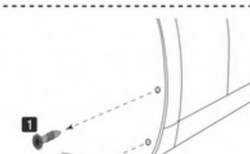
Используя шуруповерт произведите демонтаж штатных саморезов в точках 1 и 2.
