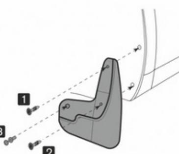
В точках 1 и 2 установите штатные саморезы. В точке 3 просверлите отверстие, используя сверло  $\varnothing 8$  мм, установите пластиковый фиксатор из комплекта поставки.
