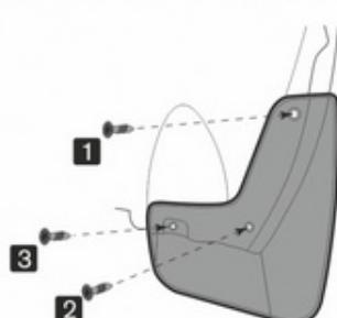
Используя отвертку со шлицем TORX, зафиксируйте брызговик, установив, ранее демонтированные, штатные саморезы. **ВНИМАНИЕ!** При необходимости воспользуйтесь крепежом из комплекта поставки.
