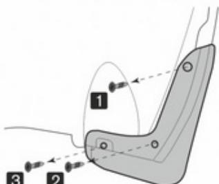
Используя отвертку со шлицем TORX, произведите демонтаж штатного крепежа и брызговика (при наличии).
