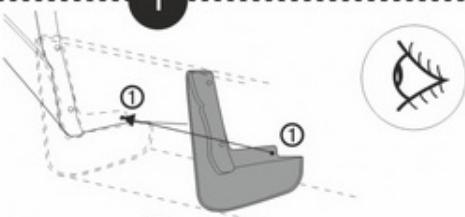
Произведите визуальную примерку, приложив изделие к месту планируемой установки. Согласно отверстию 1 на брызговике, отметьте точку для сверления в колесной арке.
