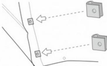
Используя сверло Ø 8 мм просверлите отверстие в отмеченном месте.
