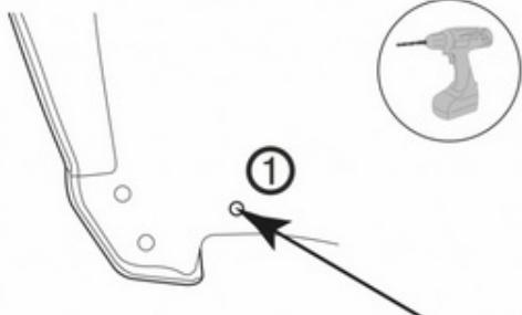
Используя сверло Ø 8 мм, просверлить
