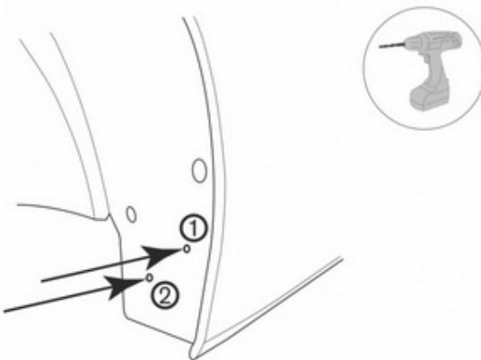
Используя сверло Ø 8 мм, просверлите отверстия в отмеченных местах. Внимание! Центр сверления в точке 1 должен совпасть с прямоугольным пазом в детали, находящейся под подкрылком. Внимание! Центр сверления в точке 2 должен попасть в пространство между ребрами в детали, находящейся под подкрылком.
