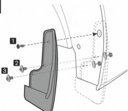
Установите саморез из комплекта поставки в точке 1. В точке 2 и 3 установите винт, шайбы и гайку из комплекта поставки.
