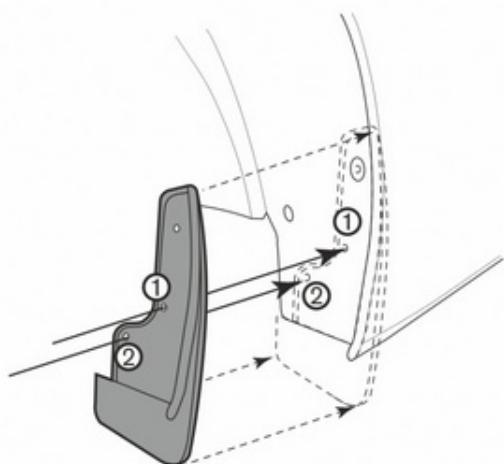
Произведите визуальную примерку, приложив изделие к месту планируемой установки. Согласно отверстию 1 и 2 на брызговике, отметьте точки для сверлений в колесной арке.
