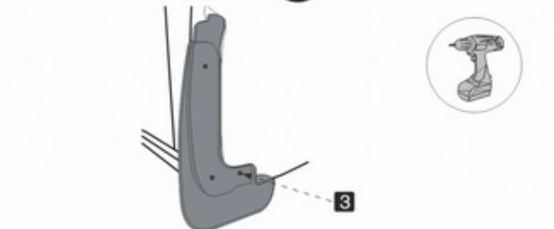
Используя шуруповерт со сверлом Ø 8 мм просверлите отверстие в точке 3.
