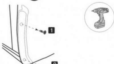
Используя шуруповерт с насадкой T20 произведите демонтаж штатных саморезов в точках 1 и 2.
