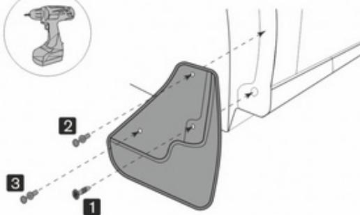
В точке 1 установите штатный саморез. В точках 2 и 3 просверлите отверстия, используя сверло Ø8 мм, установите пластиковые фиксаторы из комплекта поставки.
