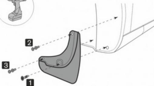
В точке 1 установите штатный саморез. В точках 2 и 3 просверлите отверстия, используя сверло Ø8 мм, установите пластиковые фиксаторы из комплекта поставки.
