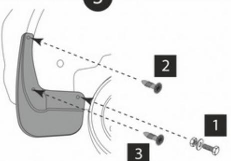
В точку 1 установить винт, гайку и шайбу из
