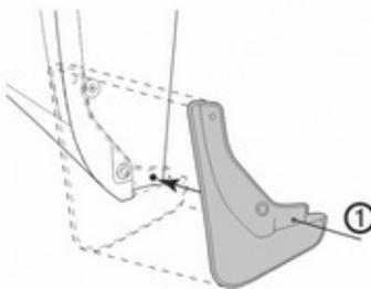
Произведите визуальную примерку, приложив изделие к месту планируемой установки. Согласно отверстию 1 на брызговике, отметьте точку для сверления в колесной арке.
