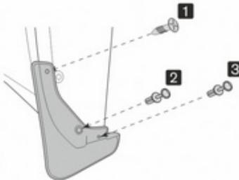
В точке 1 установите саморез из комплекта поставки. В точках 2 и 3 установите пластиковые фиксаторы из комплекта поставки.
