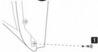
Используя крестообразную отвертку, произведите демонтаж штатного пластикового фиксатора в точке 1.
