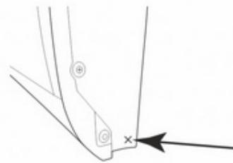
Используя сверло Ø 8 мм, просверлите отверстие в отмеченном месте.
