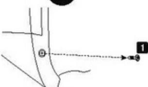
Используя крестообразную отвертку, произведите демонтаж штатного самореза в точке 1.
