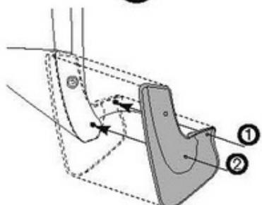
Произведите визуальную примерку, приложив изделие к месту планируемой установки. Согласно отверстиям 1 и 2 на брызговике, отметьте точки для сверления в колесной арке.
