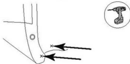
Используя сверло Ø 8 мм, просверлите отверстия в отмеченных местах.
