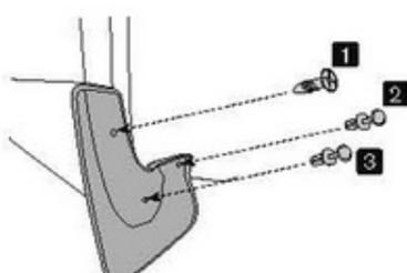
В точке 1 установите ранее демонтированный штатный саморез. В точках 2 и 3 установите пластиковые фиксаторы из комплекта поставки.
