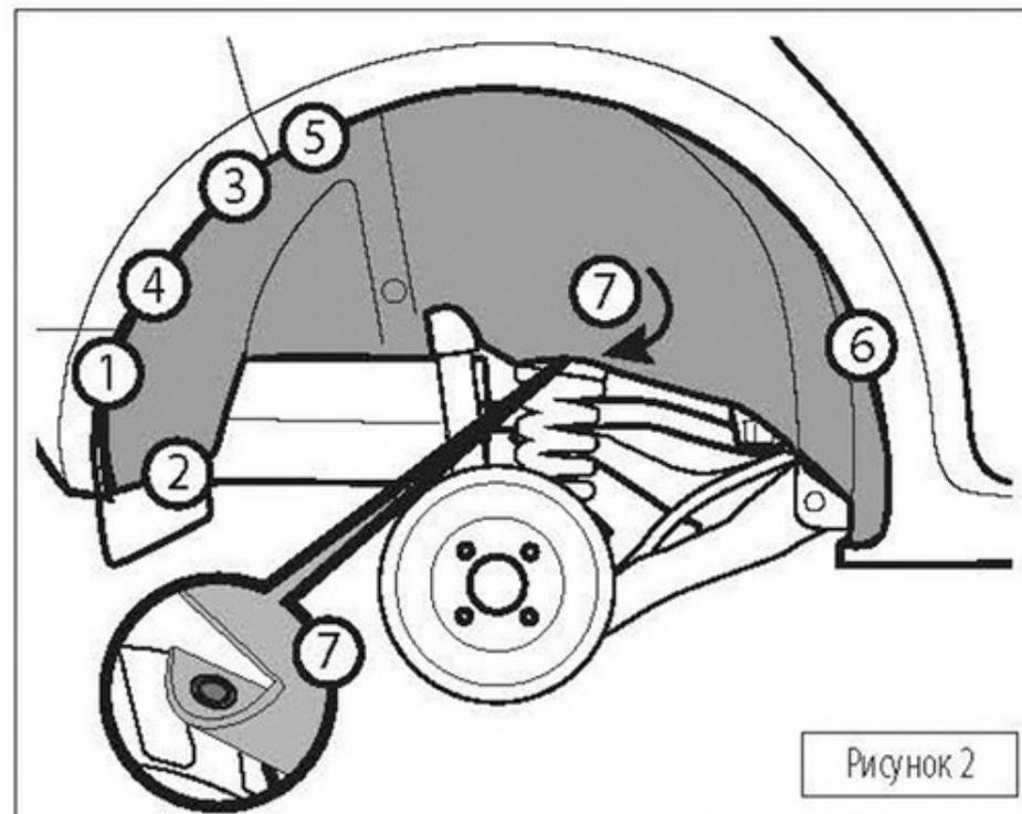
Зафиксировать подкрылок (точки 1, 2, 3, 4, 5, 6), используя элементы штатного крепежа и соблюдая последовательность, указанную на рисунке 2 в кругах белого цвета. Загнуть язычок подкрылка так, как показано на изображении и зафиксировать пластиковым фиксатором из комплекта поставки в точке 7. Установить колесо (момент затяжки болтов смотри в руководстве по ремонту автомобиля).
