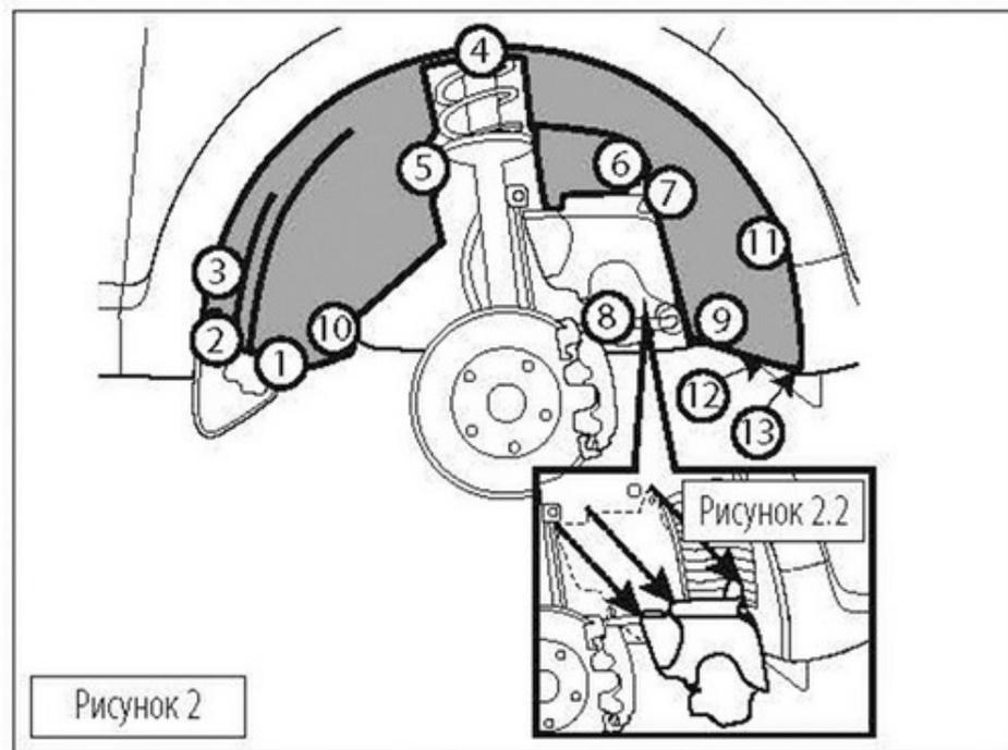
Установить штатный пластиковый элемент (Рисунок 2.2), зафиксировать штатными элементами фиксации (точки 7–9).
