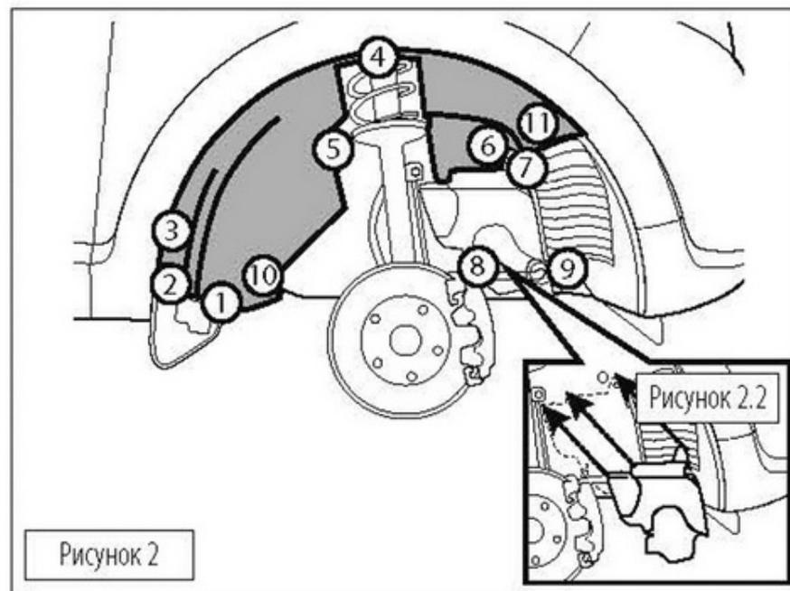
Снять колесо. Демонтировать штатные крепежные элементы в точках, отмеченных черными кругами на рисунке 1. Снять штатный пластиковый элемент (Рисунок 1.2).
