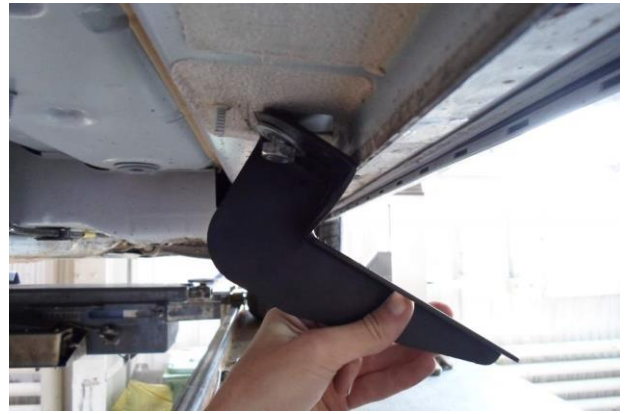
Рис.5 Установка среднего кронштейна
