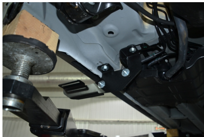
Рис. 4 - Установка задних кронштейнов
