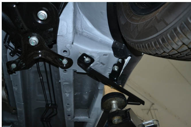
Рис. 3 - Установка передних кронштейнов
