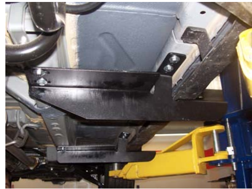
Рис.5 Установка заднего кронштейна
