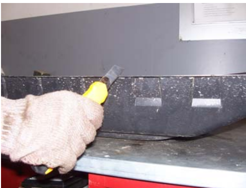
Рис.6 Пазы в пластиковом пыльнике
