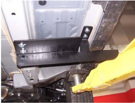
Рис.4 Установка переднего кронштейна
