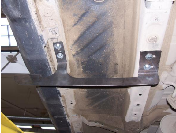
Рис.4 Установка переднего кронштейна
