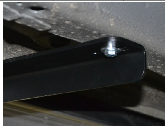
Рис. 2а - Установка передних кронштейнов
