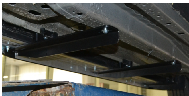
Рис. 2а - Установка передних кронштейнов
