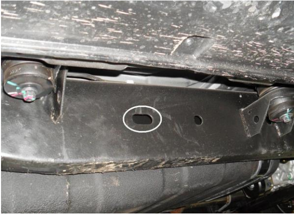
Рис. 6 Место крепления заднего кронштейна
