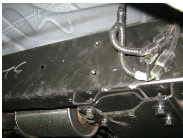
Рис. 2 Место крепления переднего кронштейна справа
