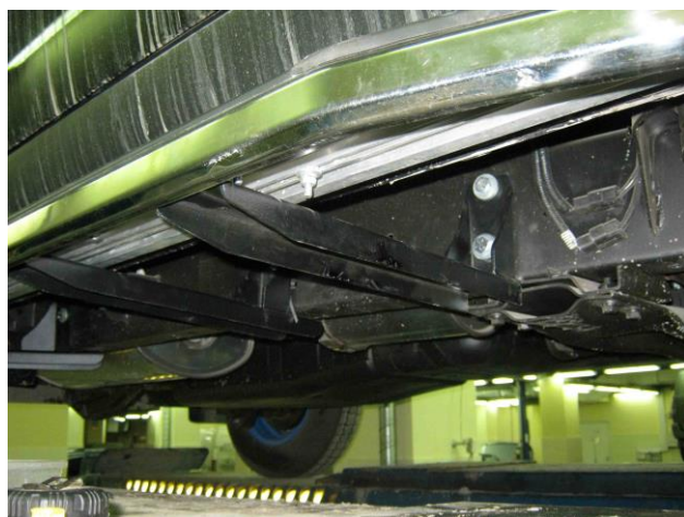
Рис. 3 Установка переднего кронштейна
