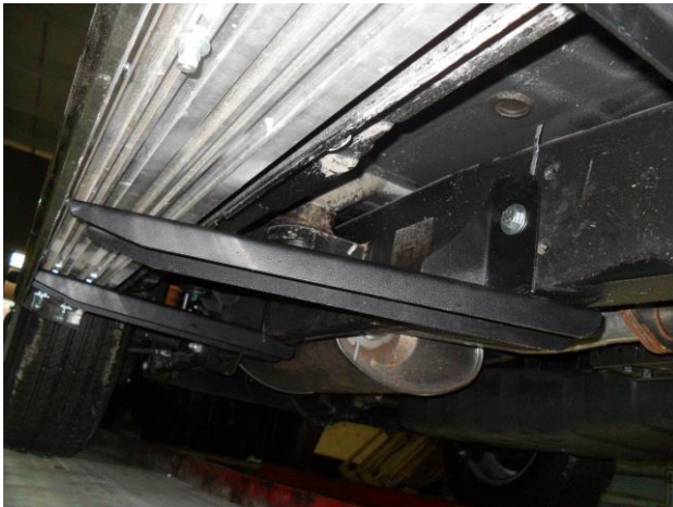
Рис. 8 Крепление среднего кронштейна
