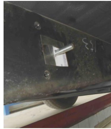
Рис. 7 Установка шпильки закладной М10
