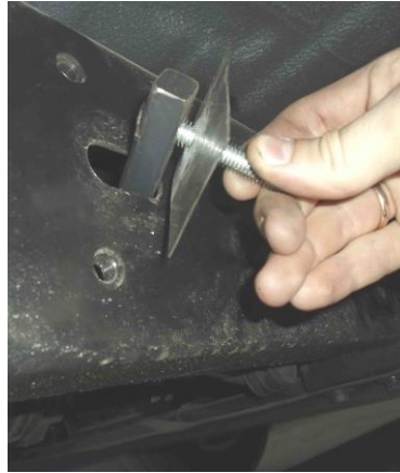
Рис. 7 Установка шпильки закладной М10
