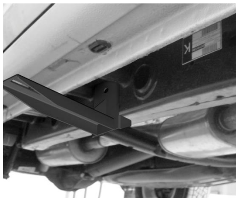
Рис.6 Установка среднего кронштейна
