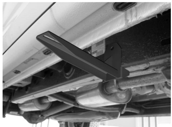
Рис.7 Установка переднего кронштейна
