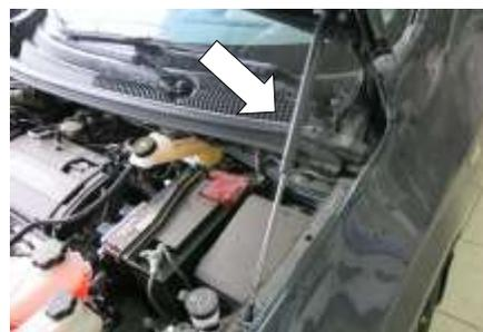
3. Прокачать амортизатор (упереть в твердую поверхность, несколько раз полностью сжать и отпустить).
