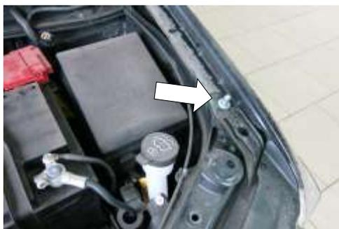
1. Открутить болт крепления крыла и установить вместо него болт-шарнир с шайбой, как показано на рисунке. Затянуть болт ключом №10 с усилием 9 Нм.
