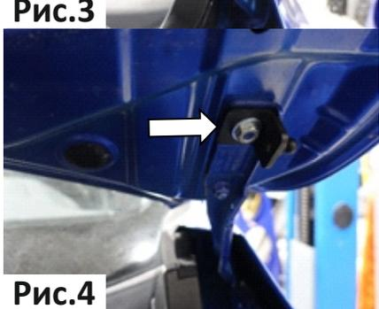
4. Установить кронштейн, уперев его в ребро жесткости петли. Закрепить кронштейн гайкой М8 с шайбой 10. Затянуть гайку торцевой головкой №13 с усилием 23 Нм, (Рис.4).
