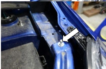
2. Вкрутить болт-шарнир с шайбой 6. Затянуть болт-шарнир высокой торцевой головкой №10 с усилием 9 Нм, (Рис.2).
