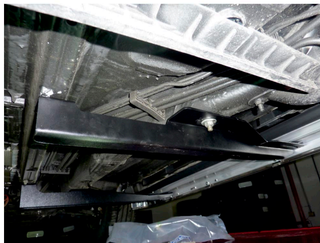
Рис. 4 - Установка среднего кронштейна
