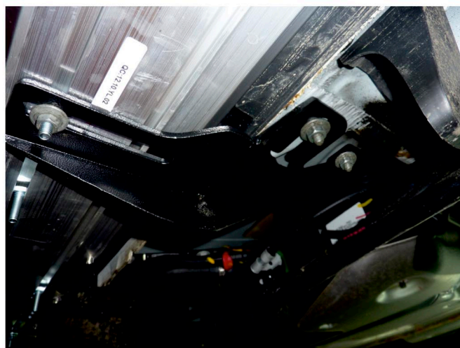
Рис. 6 - Установка заднего кронштейна
