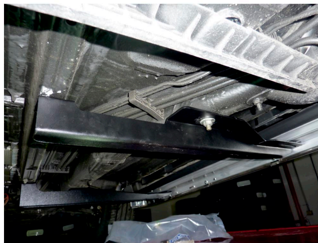
Рис. 4 - Установка среднего кронштейна
