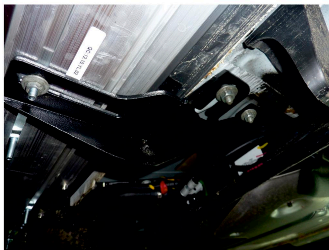
Рис. 6 - Установка заднего кронштейна
