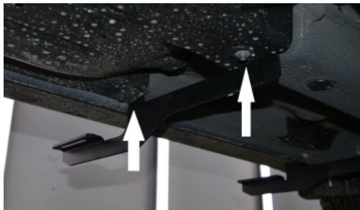
Рис. 4 - Установка среднего кронштейна
