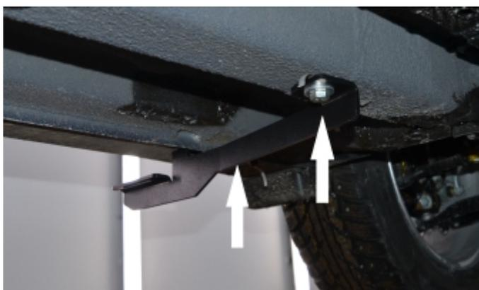
Рис. 3 - Установка переднего кронштейна
