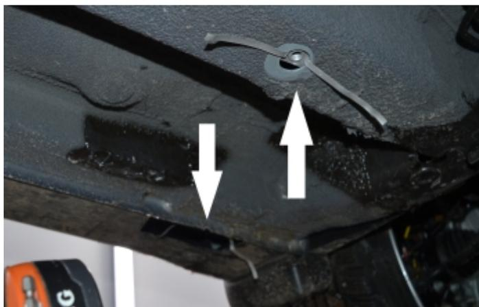
Рис. 1 - Установка фиксируемых гаек в передней части автомобиля
