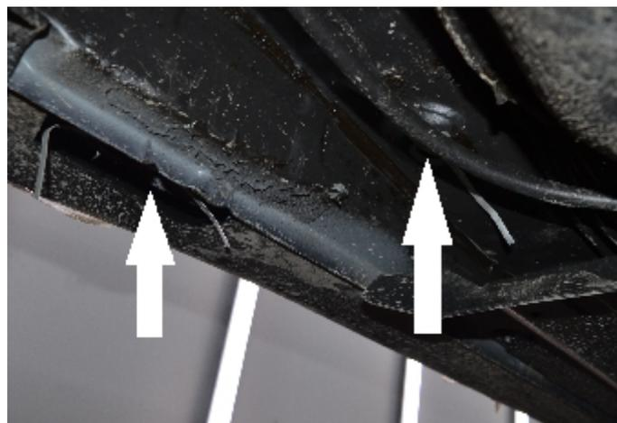
Рис. 2 - Установка фиксируемых гаек в задней части автомобиля
