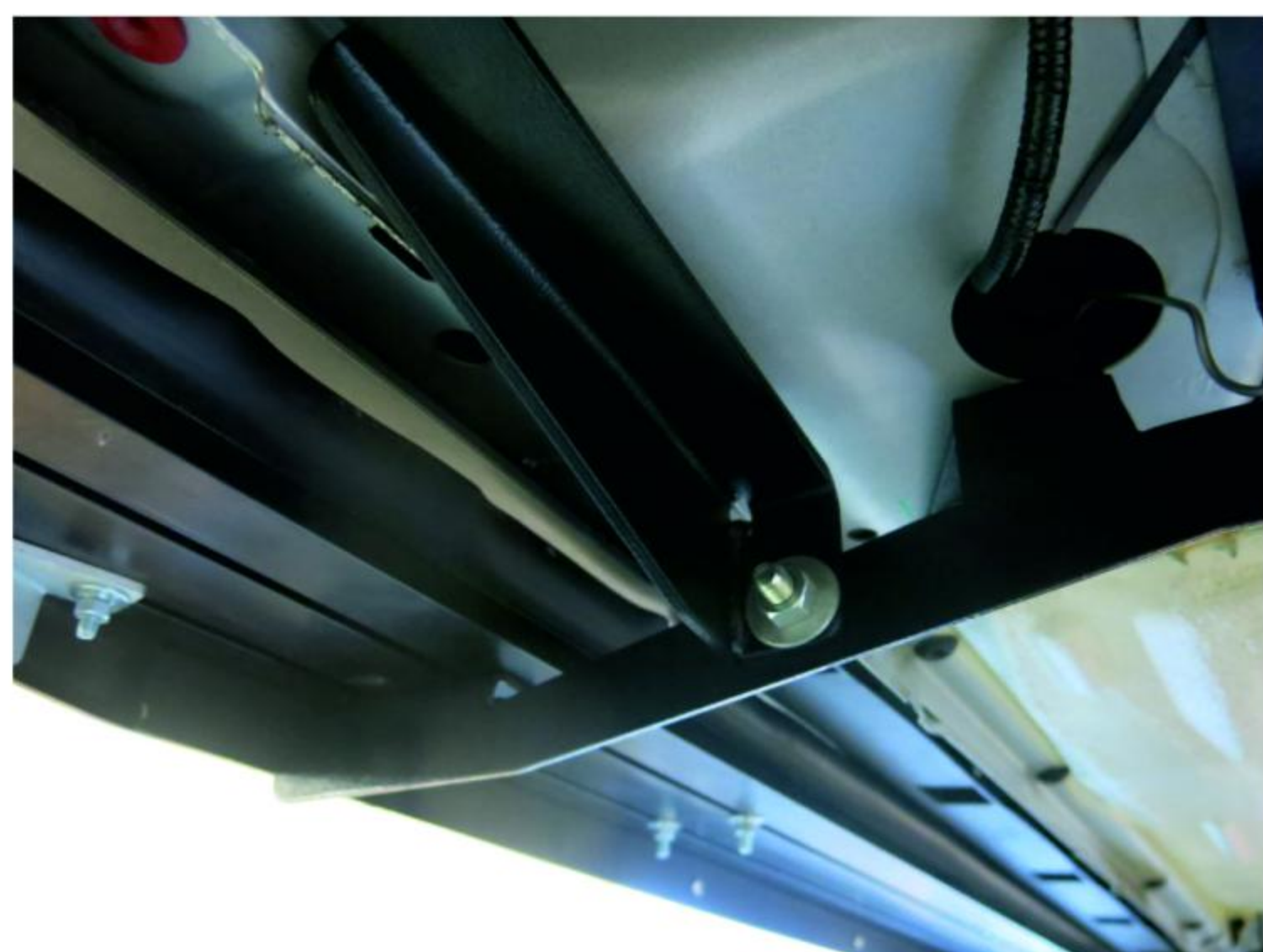
Рис. 3 - Стягивание задних кронштейнов
