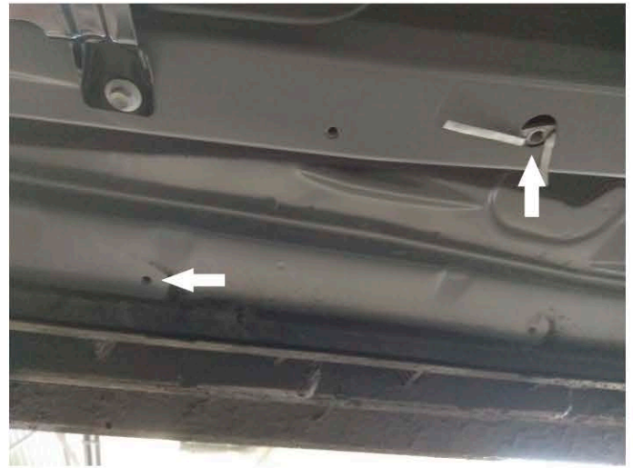
Рис. 2 - Места крепления среднего кронштейна
