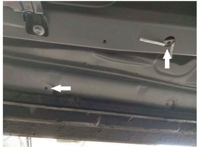
Рис. 2 - Места крепления среднего кронштейна
